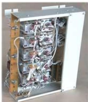
Тиристорные пускатели предназначены для бесконтактной коммутации и защиты в аварийных режимах работы трехфазных двигателей и другой активно-индуктивной нагрузки, обеспечивают выполнение функций пускателей и автоматических выключателей.
